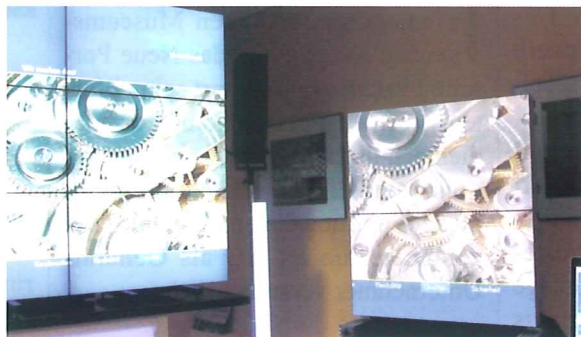
Linienstrahler, DMX-gesteuerte LED-Scheinwerfer, Vergleich LCD- (links)/Plasma-Displays
